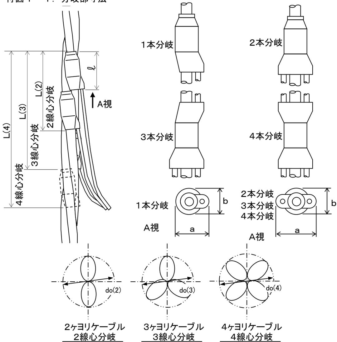
(注) ケーブル貫通孔は、 $do + 20\text{mm}\phi$  以上の孔を開けてください。
